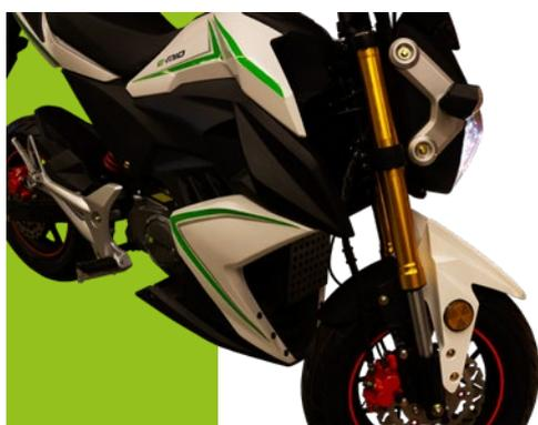
horquilla delantera invertida („upside-down“) permite una amortiguación en la carretera con baches y desniveles
